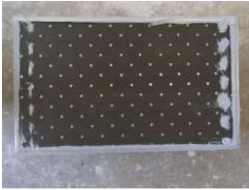
写真 3.3.4 試験体側面シール
