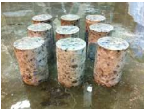
写真 3.4.1 下地コンクリートのコア抜きサンプル
