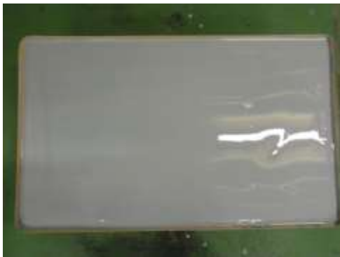
写真 3.3.6 ウレタン塗膜防水塗布
